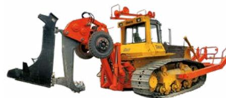
Engin de pose du câble KVH2 (KVH1) à la base du TM10.00 HST 12
