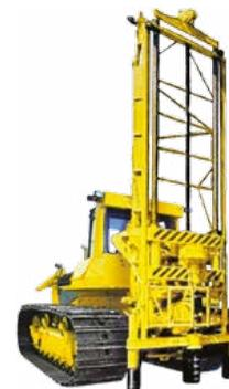
Engin de forage multi-usage sur le châssis TM10.00B HST 9
