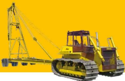
Grue remorquée sur le châssis TM10.00B HST9
