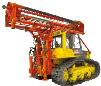
Engin de forage multi-usage sur le châssis TM10.00B HST 9
