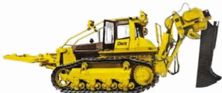
Engin de posage du câble KVH 220 sur le châssis TM10.00 HST9
