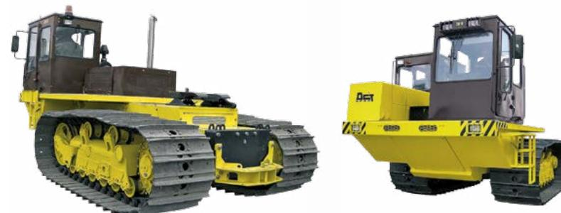
Tracteur à chenilles TM10.00B HST9 MT01 - une plate-forme pour équipements spéciaux. La machine est conçue pour transporter et assurer un organe de puissance d'un engin de damage. En général, le groupe est destiné à la construction de routes - «routes d'hiver».
