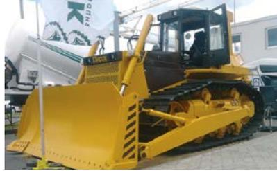
Lancement de la production de série d'un nouveau bulldozer TM10 à transmission hydrostatique - THS Bosch-Rexroth. Le choix du THS est déterminé par l'expérience de l'utilisation de ce type de transmission par les principaux fabricants: Liebherr, CAT, Komatsu, John Deere, CHETRA. Les robots de soudage KAWASAKI et MOTOMAN sont mis en œuvre pour la production des nœuds délicats.
