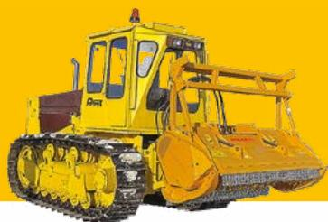
Broyeur à commande hydraulique sur le châssis TM10.00 HST9
