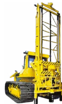
Instalación perforadora multiuso sobre chasis TM10.00B GCT 9
